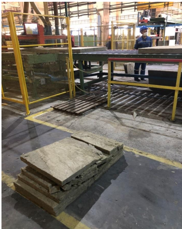
Рисунок 9.4.4 Образование и накопление сухих отходов теплоизоляционного материала на основе базальтового волокна
