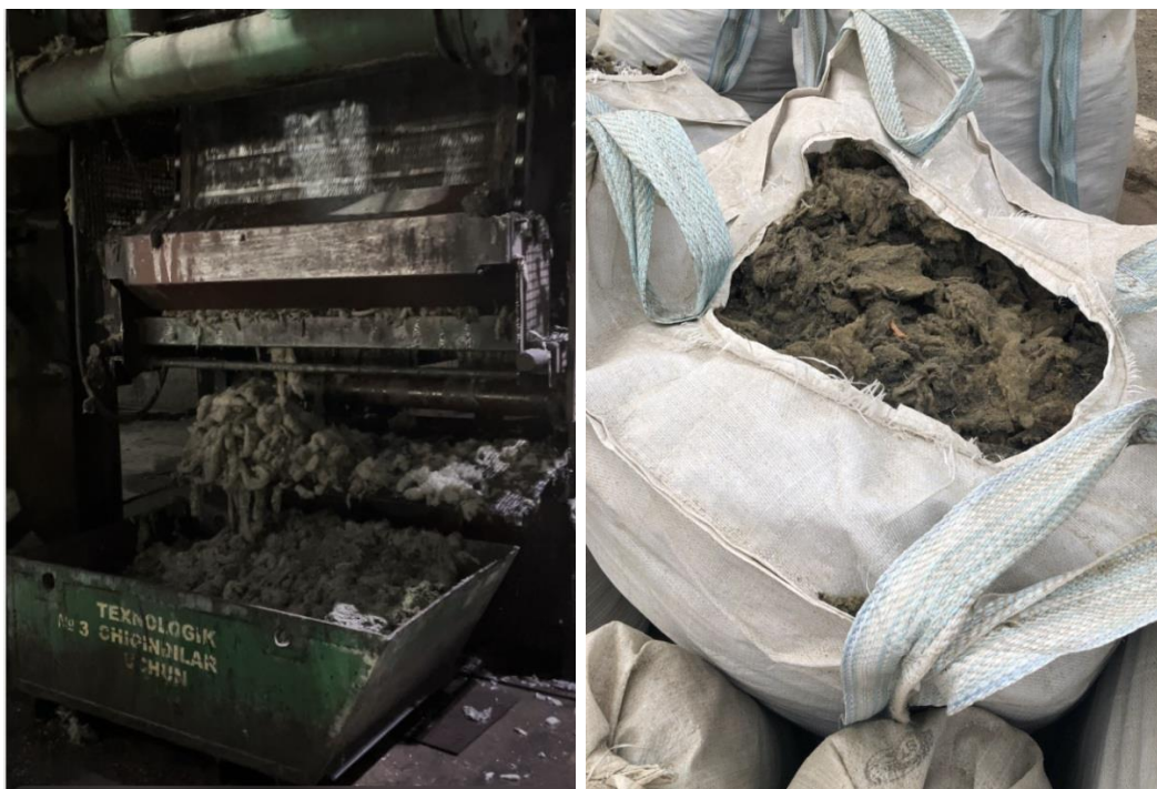
Рисунок 9.4.3 Образование и накопление влажных отходов теплоизоляционного материала на основе базальтового волокна
